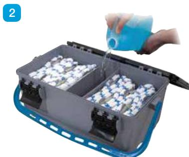
2 Mittels der Dosierkanne die angesetzte Reinigungsflotte in die Dosierkammer füllen.
