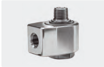
1/4" IG : 1/4" AG. DN 7. Max. 275 bar / 30 U/min / 120 °C
