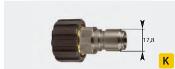
Stecknippel : IG. Edelstahl + Messing. Max. 250 bar / 150 °C
