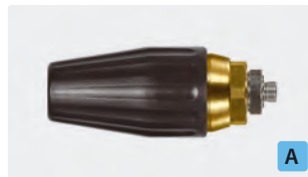
1/8" AG. Spritzwinkel 20°. 100 - 250 bar. Max. 100 °C
