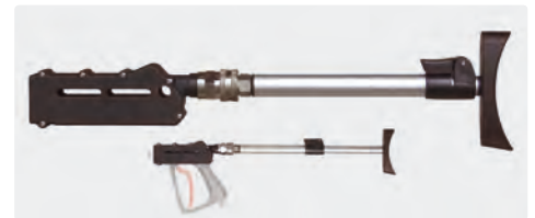
ST-3900 Schulterstützen. Neue EU-Richtlinien schreiben den Gebrauch von Schulterstützen bei Arbeiten mit einer Rückstoßkraft von mehr als 150 N zwingend vor. Stufenlos verstellbare Schulterstütze. Drehbare Kupplung. Geeignet für alle Pistolen ST-3600 / ST-3500.
