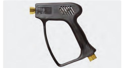
Professionelle Pistole ohne Ventil (Freifluss). Max. 275 bar / 45 l/min / 150 °C
