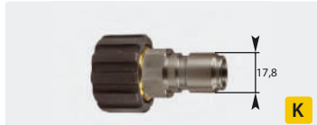
Stecknippel : IG. Edelstahl + Messing. Max. 250 bar / 150 °C
