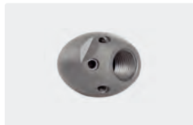
1/4" IG. 6x 75° +1x 0°. 20-50 l/min. Für \text{R} \text{Ø} 50-100 mm. Außen \text{Ø} 30 mm. \text{Ø} 127 g.
