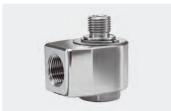
3/8" IG : 1/4" AG. DN 7. Max. 150 bar / 30 U/min / 90 °C
