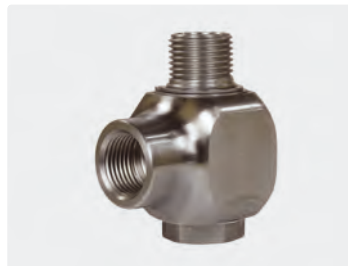
1/2" IG : 1/2" AG. DN 12. Max. 30 U/min / 90 °C
