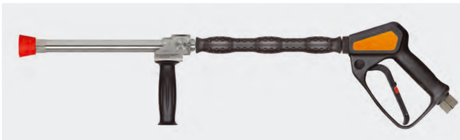
1/2" IG. Edelstahl. Weitwurflanze 350 mm mit Isolierung ST-29 Cool & Compact 330 mm, Pistole ST-2320, seitlichem Handgriff und Düsenschutz aus Kunststoff ohne Düse. Max. 150 bar / 80 l/min / 100 °C
