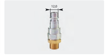
Stecknippel : AG. \varnothing 12 mm. Stahl gehärtet, chemisch vernickelt/ verzinkt und Messing. Max. 200 bar / 100 °C
