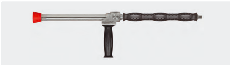
1/4" AG. Edelstahl. Weitwurflanze 350 mm mit Isolierung ST-29 Cool & Compact 330 mm, seitlichem Handgriff und Düsenschutz aus Kunststoff ohne Düse. Max. 280 bar / 130 l/min / 100 °C
