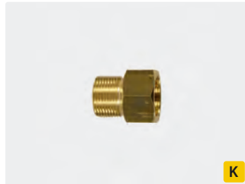
M22 IG : M22 AG. K 2000. Messing. Max. 400 bar
