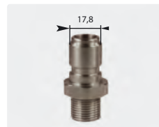
Stecknippel : AG. Edelstahl. 60° Dichtkonus. Max. 250 bar / 150 °C
