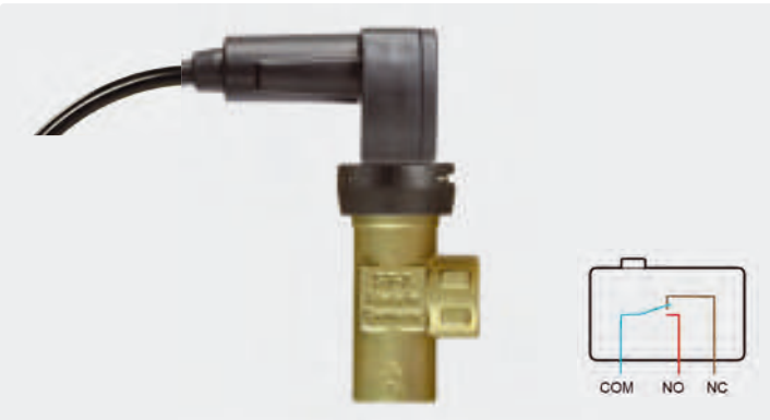
3/8" IG. Schutzklasse IP65. Kabel 1.200 mm. 10 A. 250 V. Einschaltstrom 20 A (Öffner) und 15 A (Schließer). Max. 350 bar / 45 l/min / 80 °C
