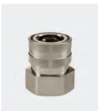
ST-45. Messing vernickelt. Kupplung : 1" IG. 25 bar / 90° C
