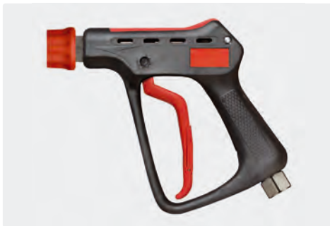
Professionelle Höchstdruckpistole mit Kupplung ST-45. Max. 600 bar / 80 l/min / 150 °C
