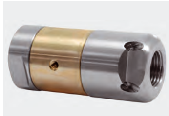
1/2" IG. 4 Bohrungen hinten. 3 Bohrungen seitlich. Außen \varnothing 38 mm. 580 g.
