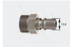
Stecknippel : AG. Edelstahl. Max. 350 bar / 100 °C
