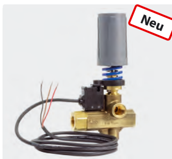
☉ = Eingang 3/8" IG. ☉ = Ausgang 3/8" IG. [BP] = Bypass 3/8" IG. Kugel-Rückschlagventil. Umlaufventil mit Schalter (IP65) und Kabel 1.200 mm. Max. 350 bar / 80 °C
