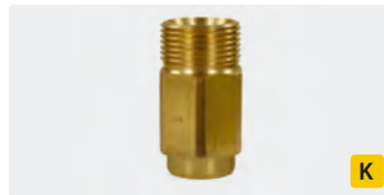
M22 AG : IG. Messing. Langbohrung. Max. 400 bar
