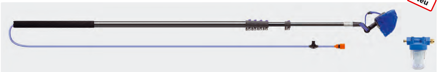
Alu-Teleskoplanze mit 4 oder 5 Clipverschlüssen und Softgriff 570 mm. High-Low Waschbürste mit Nylonhaaren an Winkelverstellung, 8 oder 12 m Schlauch Ø 8 mm, Kugelhahn und Universalanschluss. 5" Filter und Filtereinsatz Polyphosphate mit Anschluss 3/8" Kupplung und Hahnenstück.
