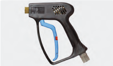
Professionelle Pistole. Frostschutzausführung. Max. 275 bar / 45 l/min / 150 °C
