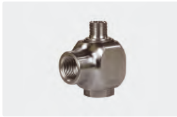
1/2" IG : 3/8" AG. DN 10. Max. 30 U/min / 90 °C
