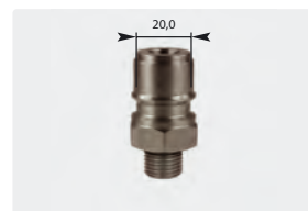
Stecknippel : AG. Edelstahl gehärtet. Max. 250 bar / 150 °C
