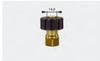
Standard M22 : IG. Schwarz. Max. 400 bar / 150 °C
