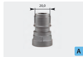
Stecknippel : IG. Edelstahl gehärtet. Max. 250 bar / 150 °C
