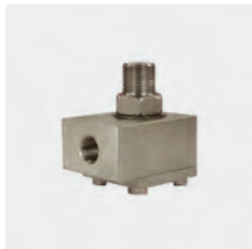
1/4" IG : 3/8" AG. Gehäuse und Achse Edelstahl. Max. 600 bar / 90 °C
