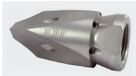
300 bar. 3/4" IG. \square 80 mm, \varnothing = 38 mm, \boxtimes 0,29 kg. Für Rohre > 80 mm. Seitliche Frontstrahlen mit gehärteten Edelstahl Düseneinsätzen.
