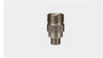
M22 AG : 1/4" AG. Langbohrung. Max. 400 bar / 150 °C
