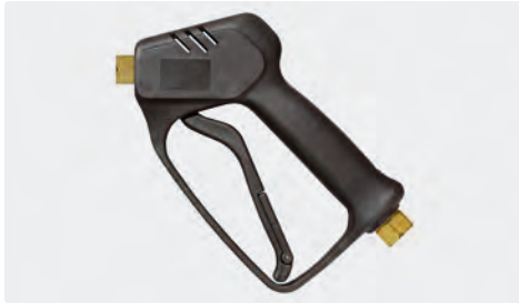
Professionelle Pistole. Max. 210 bar / 25 l/min / 150 °C
