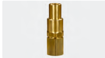
1/4" IG : 1/2" IG. Messing. Max. 250 bar / 90 °C
