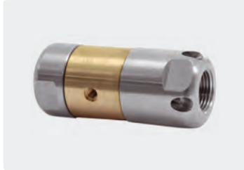
3/8" IG. 4 Bohrungen hinten. 3 Bohrungen seitlich. Außen \varnothing 30 mm. 307 g.
