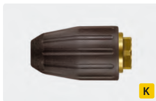
M18 IG. Spritzwinkel 20°. 200 - 350 bar. Max. 100 °C
