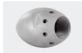
1" IG. 8x 75° +1x 0°. 100-250 l/min. Für \text{R} \text{Ø} 150-300 mm. Außen \text{Ø} 62 mm. \text{Ø} 1.265 g.
