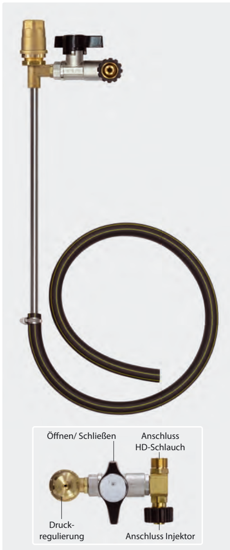
ST-230 mit Anschluss, Kugelhahn, Edelstahlrohr 400 mm und Schlauch 1.000 mm. Max. 250 bar / 30 l/min / 95 °C
