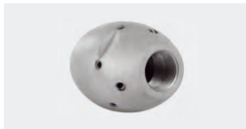
1/2" IG. 6x 75° 3x 30° +1x 0°. 80-140 l/min. Für \text{R} \text{Ø} 120-250 mm. Außen \text{Ø} 40 mm. \text{Ø} 630 g.
