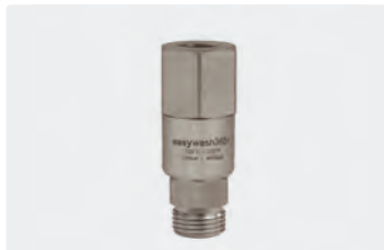
1/4" IG : M18 AG. Max. 275 bar / 120 °C
