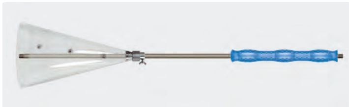
Strahlrohr mit Isolierung ST-29 Cool & Compact. Angenehm ergonomisch geformter Griff. Geschlossene Oberfläche. Mit Spritzschutztrichter, einstellbar mit Flügelschraube. Max. 400 bar / 80 °C
