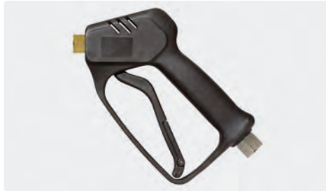
Professionelle Pistole. Max. 210 bar / 25 l/min / 150 °C
