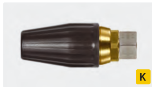
M18 IG. Spritzwinkel 20°. 100 - 250 bar. Max. 100 °C
